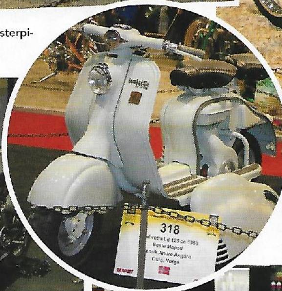
◀ Lambretta fra Innocenti ble laget omkring rør-ramme, noe som kanskje ikke er overraskende ettersom de som startet produksjonen var hjemmehørende i rørleggerfaget.
