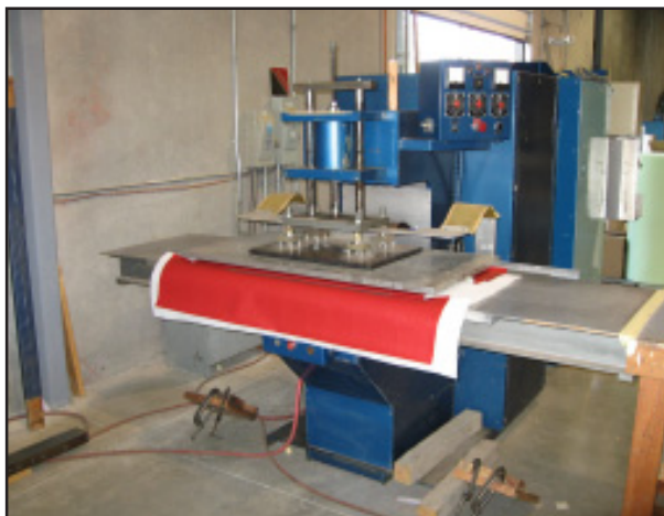
Denne maskinen varmer og presser inn mønsteret i trekket på den nye dørsiden
